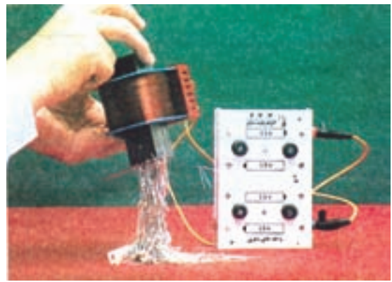
شکل ۱۳-۵- کاربرد جریان DC برای تولید مغناطیس
