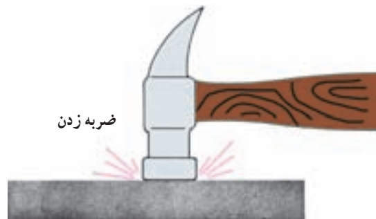
شکل ۱۴-۵- خنثی کردن اثر مغناطیسی آهن ربا با زدن ضربه
