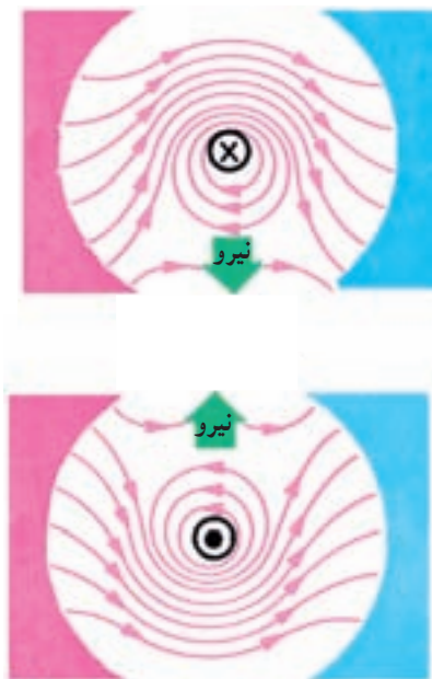
شکل ۳۶-۵ اثر میدان مغناطیسی بر سیم حامل جریان
